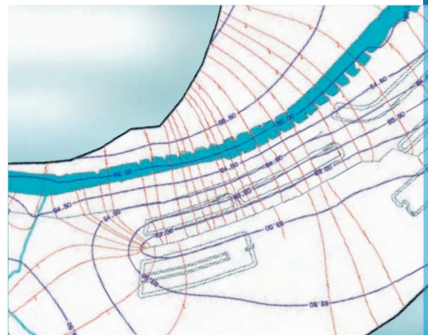
Präzise Vorhersagen: Stromlinienberechnung zur Abgrenzung und Darstellung von Einzugsgebieten und Ermittlung von Fließzeiten.
